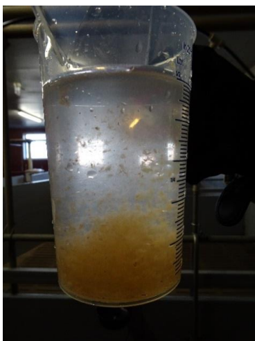
Biofilm in Hauptwasserleitung
