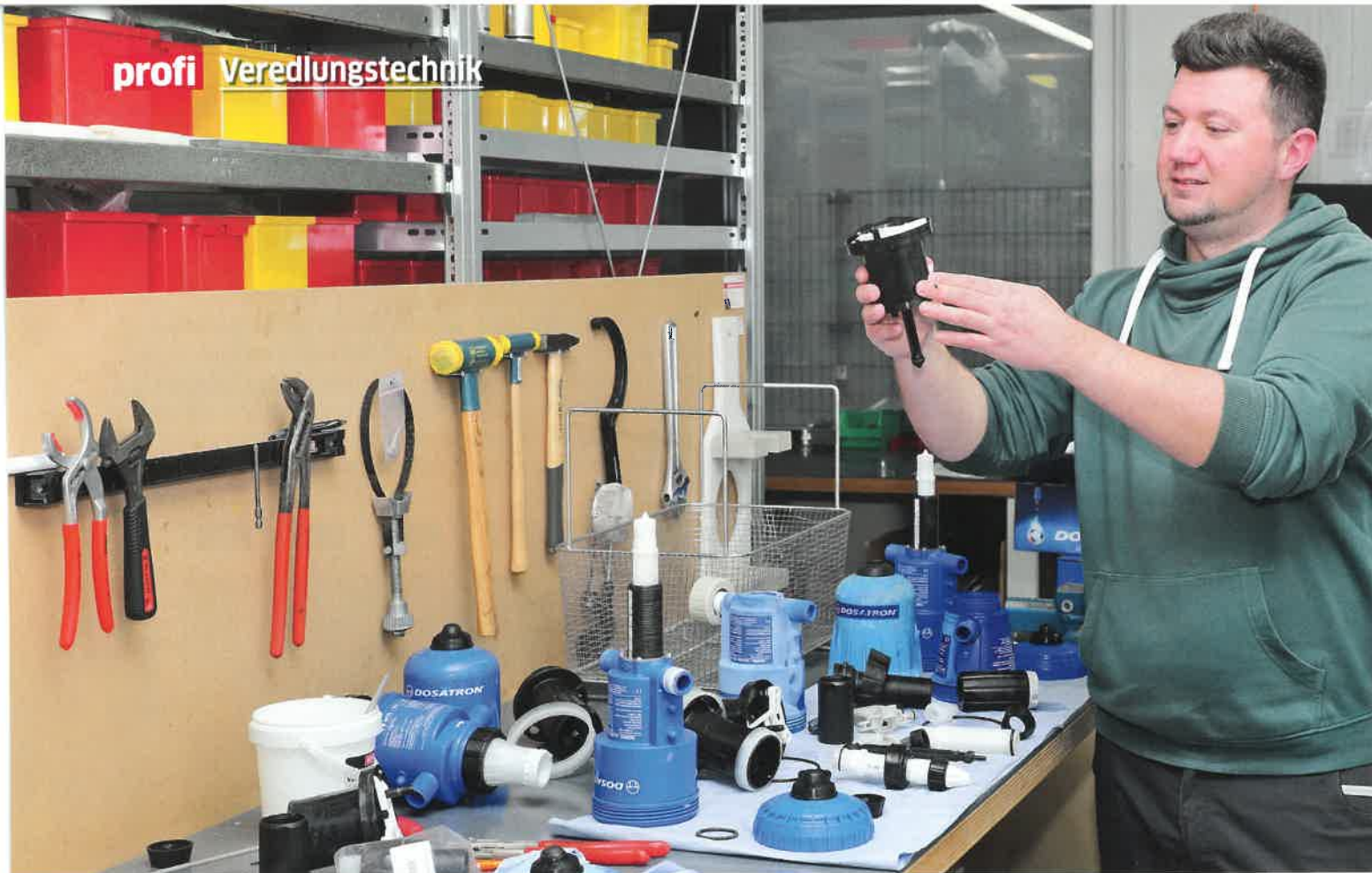
Ist der Kolben in Ordnung, oder muss er getauscht werden? – Die Firma LDT Dosiertechnik in Hamburg vertreibt nicht nur Pumpen von Dosatron, sondern repariert und überprüft sie auch. Fotos: Zäh
