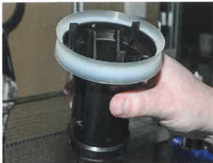
Eine defekte Kolbendichtung ist kein Beinbruch: Ein Ersatz kostet bei einer „D3“ nur wenige Euro, und die Pumpe läuft wie neu.
