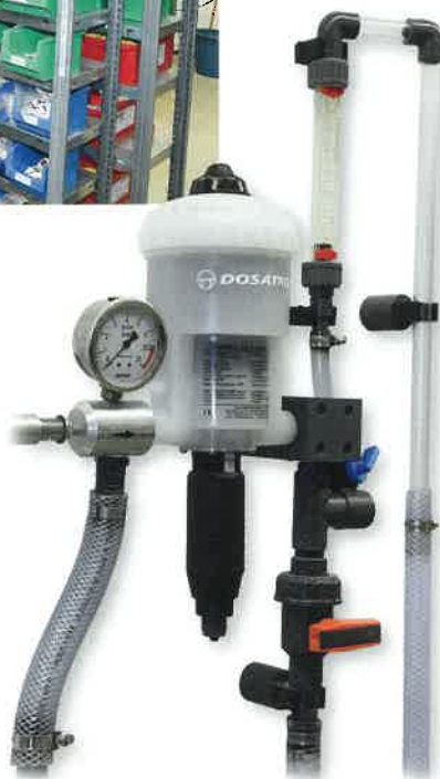
Nach der Reparatur und Reinigung wird jede Pumpe – hier eine säurebeständige Ausführung – auf dem Prüfstand getestet.
