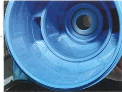
Kein Totalschaden: Wenn im Gehäuse Riefen sichtbar sind, muss die Pumpe nicht weggeworfen werden – ab 50 Euro gibt es Ersatz.
