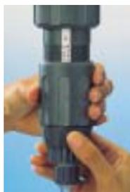
Die Einstellung der Dosierung wird durch das Drehen der Regulierverschraubung vorgenommen, deren oberer Rand mit dem gewünschten Wert auf der Dosierskala übereinstimmen muss. Die eingespritzte Konzentratsmenge ist proportional zum Wasservolumen, das den Dosatron durch-
